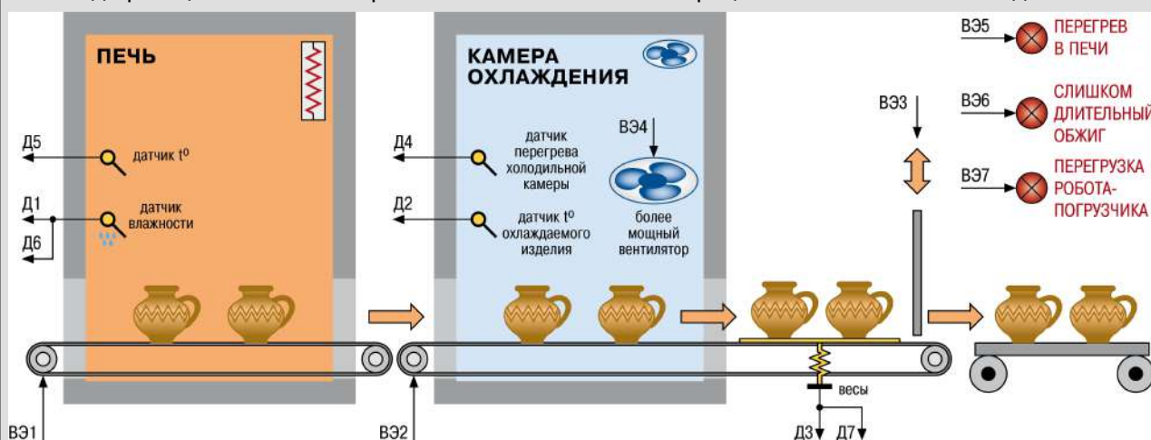
Рисунок 7.4 – Использование восьмиканального регулятора ТРМ148 второй модификации в автоматизированном процессе обжига глиняных изделий
